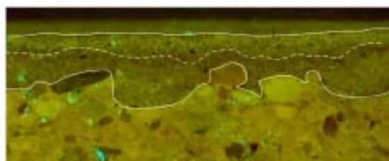
Diferenciació de les capes per fluorescència sota excitació amb llum ultraviolada de 395 nm
