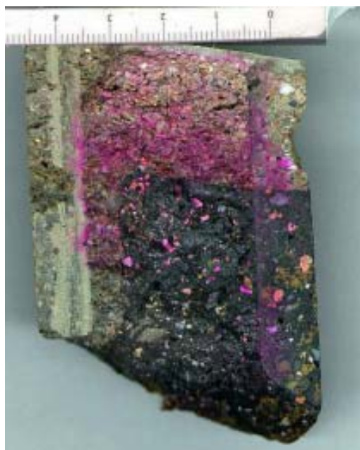
Tinció d'una fractura del revestiment amb fenolftaleïna: es veu que el front de carbonatació ha progressat molt poc. Imatge extreta de l'informe del mateix grup de treball d'abril de 2002.
