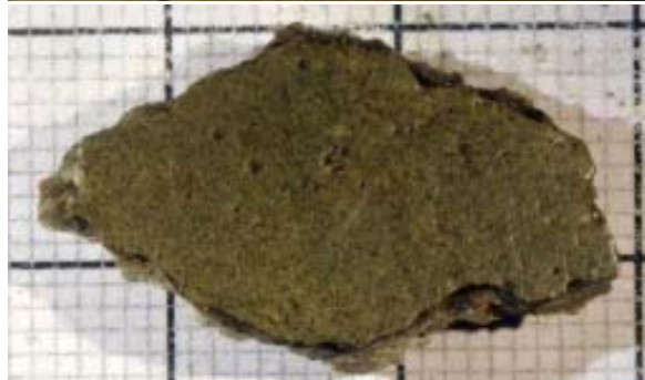
Tinció d'una fractura del revestiment amb fenolftaleïna: es veu que el front de carbonatació ha progressat molt poc. Imatge extreta de l'informe del mateix grup de treball d'abril de 2002.
